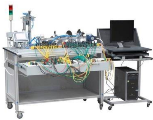
图 2 亚龙 PLC 试验台
