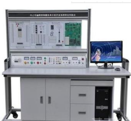
图 1 二极管 PLC 控制实训台
